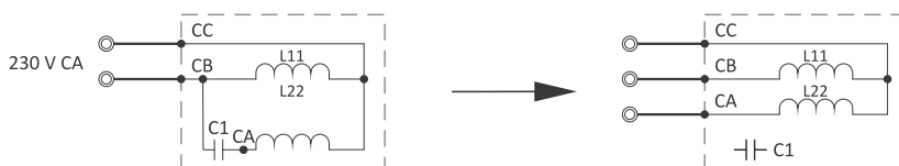
Schéma typique d'un moteur monophasé avec condensateur de démarrage
