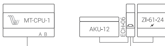
Exemple d'un système d'alimentation du récepteur 9-30 V CC
