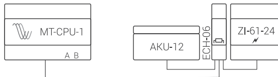
Exemple d'un système d'alimentation du récepteur 9-30 V CC
